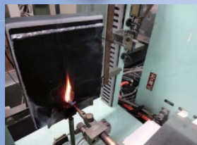
試験方法:ISO15025 A法(表面着火法) 洗濯処理:未処理
