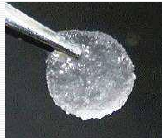
培養する細胞の足場となる部材「Genocel（ジェノセル）」
