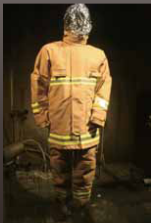
Mannequin burn test at the BTTG in Manchester, UK サーマルマネキンテスト
