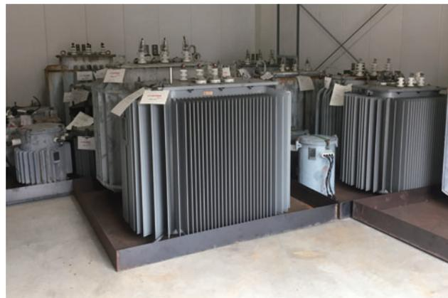
微量PCB汚染廃電気機器保管状況
